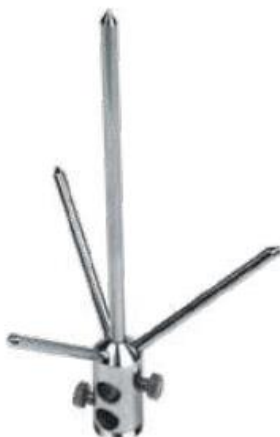
CAPTOR FRANKLIN DUAS DESCIDAS EM LATÃO CROMADO h = 350 mm
