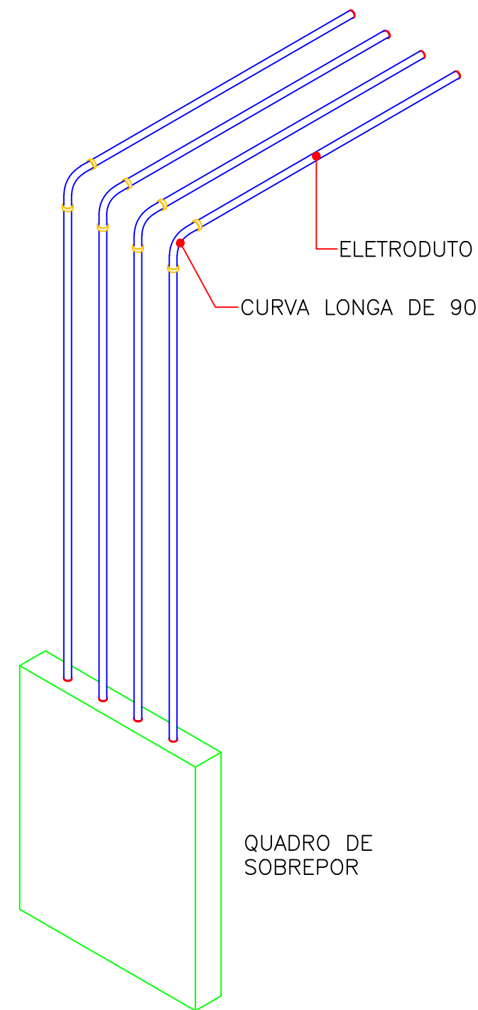
12 DET. INSTALAÇÃO QUADRO X ELETRODUTO SEM ESCALA DEFINIDA
