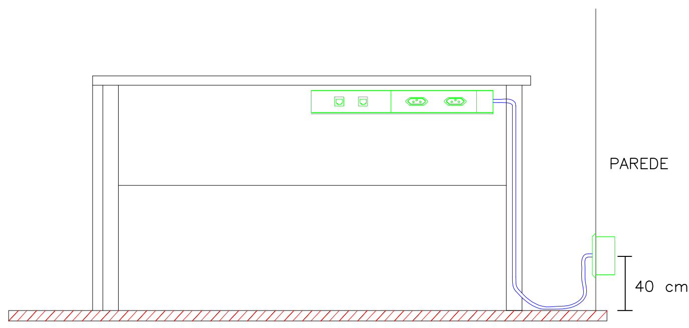
05 DET. INSTALAÇÃO TOMADA NA MESA SEM ESCALA DEFINIDA
