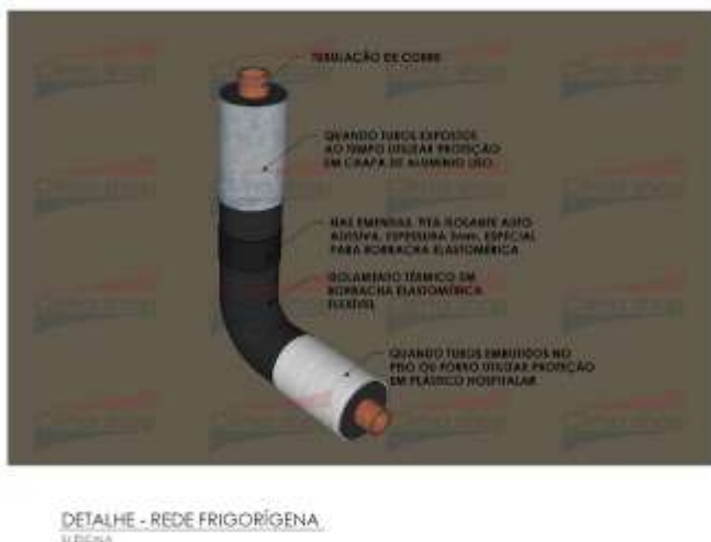
Figura 3: detalhes do isolamento térmico das tubulações frigorígenas
